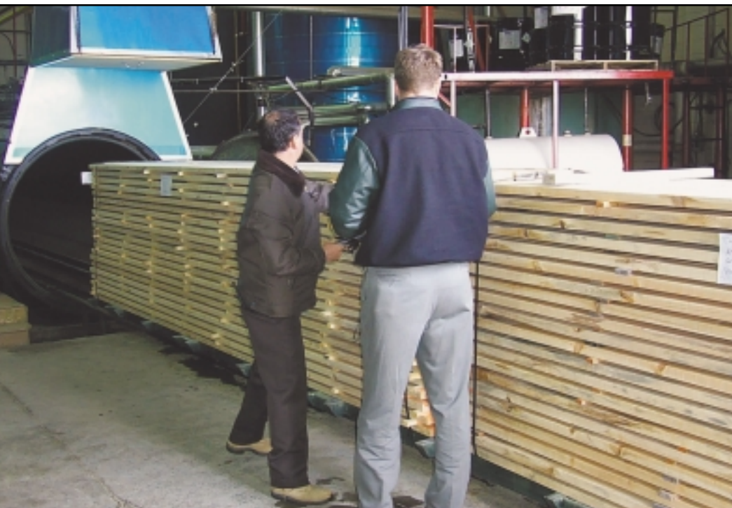
Bois d'œuvre en voie d'être glissé dans une cellule de traitement chez Les Industries Légaré Ltd.
